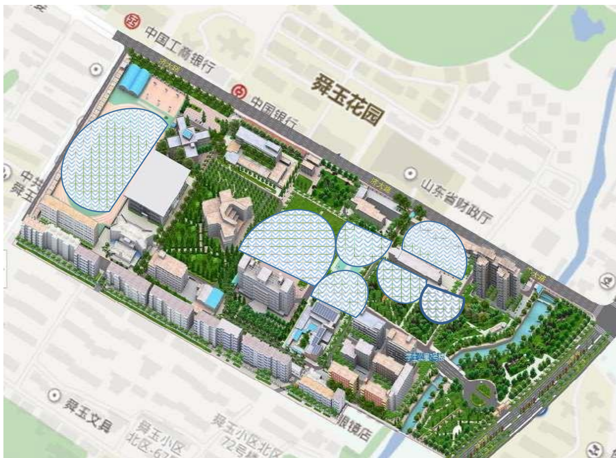
图 2-5 舜耕校区室外无线覆盖区域
